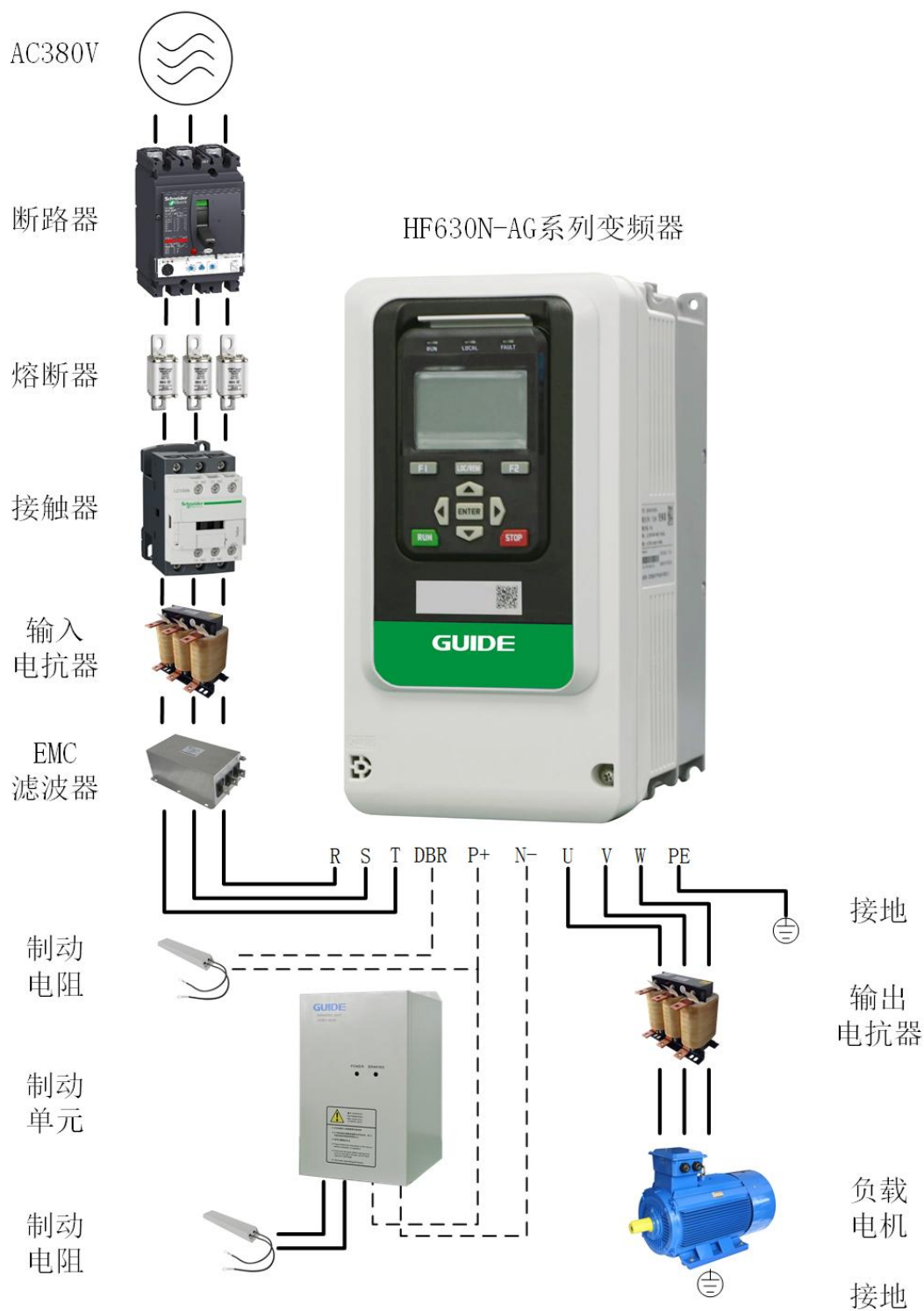
HF630-AG 变频系统外围电气元件的使用说明
